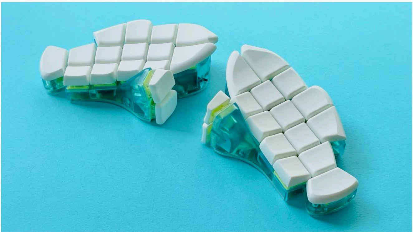
『おさかなキーボード』は以上すべての特徴に加え、Dyigma Shortcutライクな脱3×10グリッド\*、関節の向きに合わせた垂直な親指キー、段差を抑えたお椀型のキーウェルに、ステップスカルプチャーを採り入れた鞍型曲面のキーキャップ、これらの統合設計による接指角度と作用角度の独立なスタディなど、よりラディカルに身体・認知的低負荷が追求された最新鋭の造形です。
